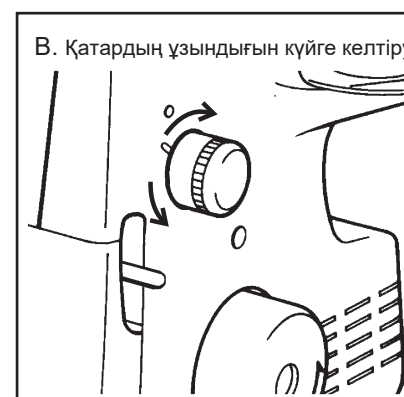
В. Қатардың ұзындығын күйге келтіру Бұрылып реттеуші, тігістің ұзындығын ұзартыңыз немесе қысқартыңыз, есу бойынша - ұзын, азайту бойынша - қысқа.
